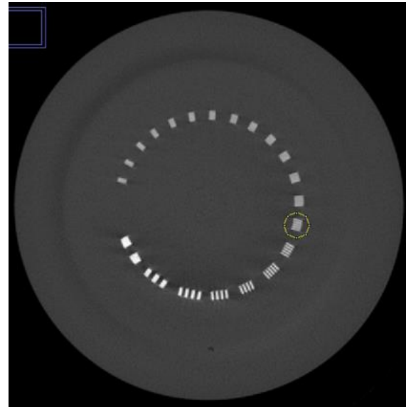
Figura 6. Imagen obtenida del módulo de resolución de alto contraste CTP528. Se observaron hasta 8 pares de líneas por centímetro en esta imagen
