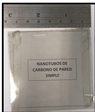
Figura 1, La foto muestra una película de SWCNTs de 80 depósitos sobre un sustrato de acetato comercial de 3 pulgadas cuadradas. El acetato se pegó en los extremos con cinta Diurex sobre un sustrato de vidrio para que el acetato no se curvara y fuera mejor el depósito de la solución empleada.
