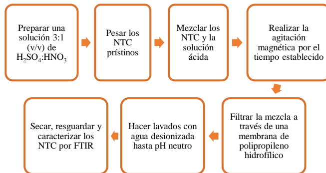
Fig. 5 Procedimiento para la funcionalización de NTC por la técnica de agitación magnética.
