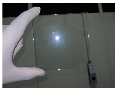
Fig. 2. Película delgada de ZnS en área grande depositada mediante la técnica DBQ.
