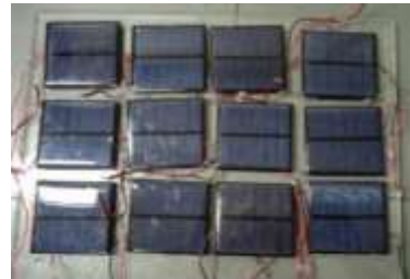
Fig. 2. Arreglo Horizontal de celdas solares (AH)
