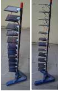
Fig. 4. Arreglo vertical B de celdas solares con una sola orientación (AVB)
