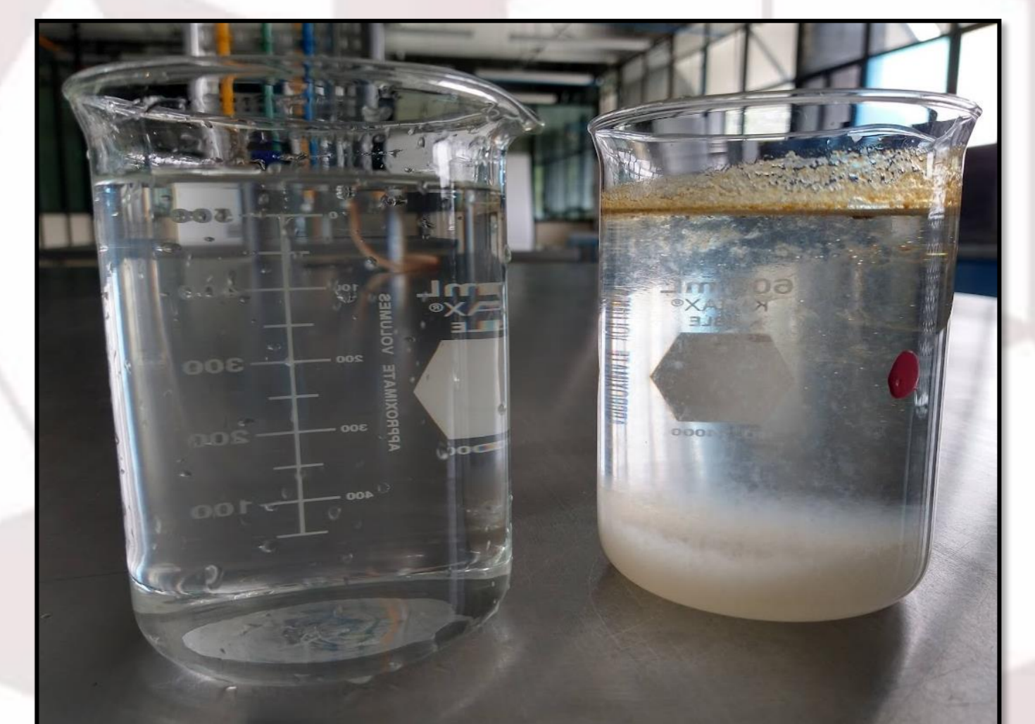
Figura 3. Análogo de agua tratada antes (derecha) y después de la filtración a vacío (izquierda).
