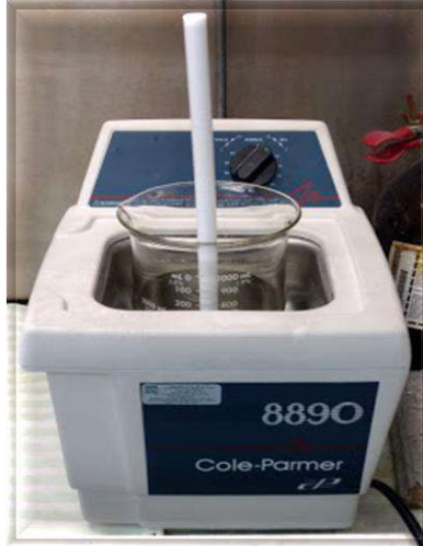
Fig. 6. Baño ultrasónico Cole – Parmer 8890, realizando el lavado de las muestras tratadas
