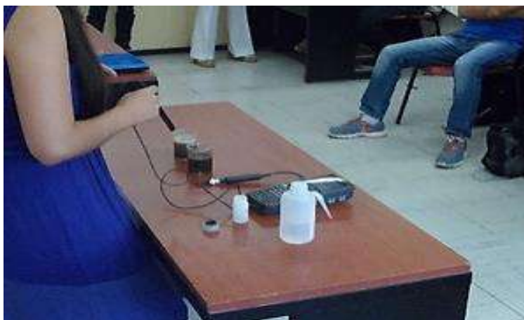
Fig. 2. Utilización del sensor de temperatura para la Calculadora TI- NSpire CX CAS I para determinar el enfriamiento de sustancias.
