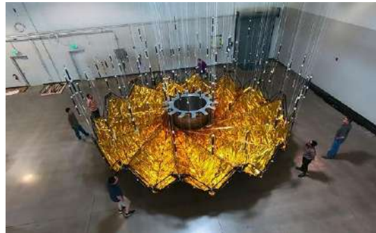
Fig.1. Despliegue de la Starshade.
