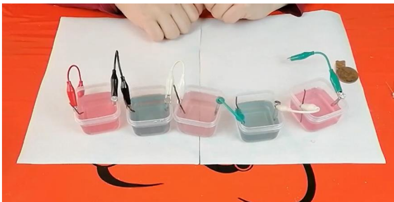
Figura 7. Conexión de los electrodos en las celdas
