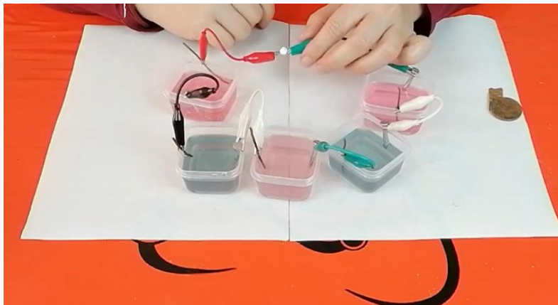
Figura 8. LED encendido con 5 celdas electroquímicas
