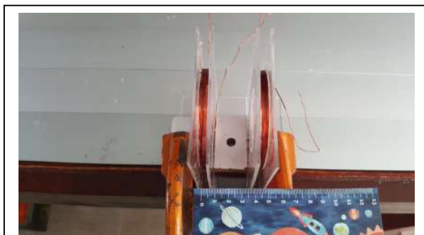
Figura 4 Los carretes con las bobinas de Helmholtz, ensamble para unir a la base.
